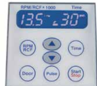
display and control interface of ScanFuge Mini
